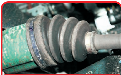
Manžety poloos trpí spíše oletujícími kameny, než že by s jejich kvalitou bylo něco špatné
