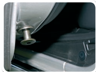
Důraz na pevnost při nárazu – čep zabraňuje prolomení zadních dveří
