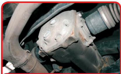
Olej v zadním diferenciálu je předepsáno měnit po 60 000 km
